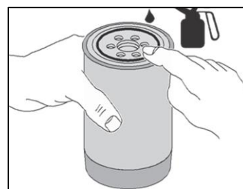
Рис. 5.3.1Т Нанесение смазки на уплотнение
