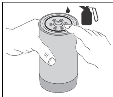
Рисунок 5.3Ю Нанесение смазочного масла на уплотнение ф/э
