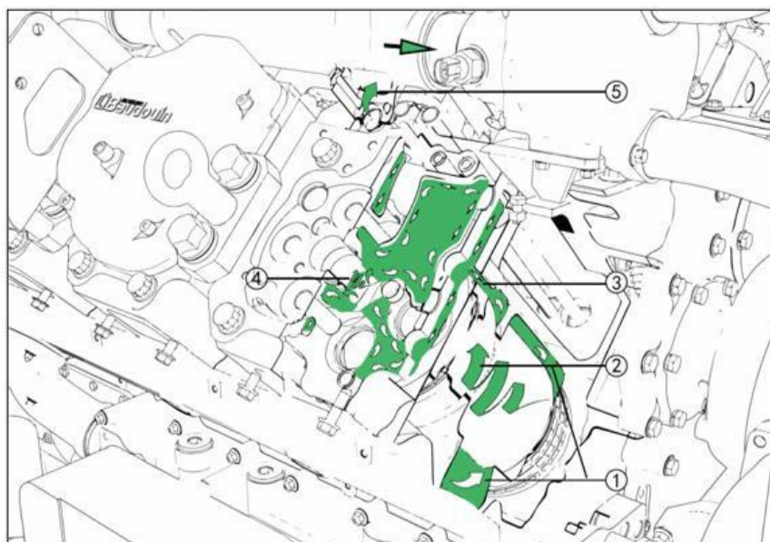
Рисунок 2.4.1В – Схема циркуляции ОЖ вдоль гильзы цилиндра. Двигатель 16М33 1 – Поток ОЖ перед гильзой, 2 – Гильза цилиндра, 3 – Поток ОЖ вдоль стенки цилиндра, 4 – Колодец свечи зажигания, 5 – Выход ОЖ в собирающий коллектор
