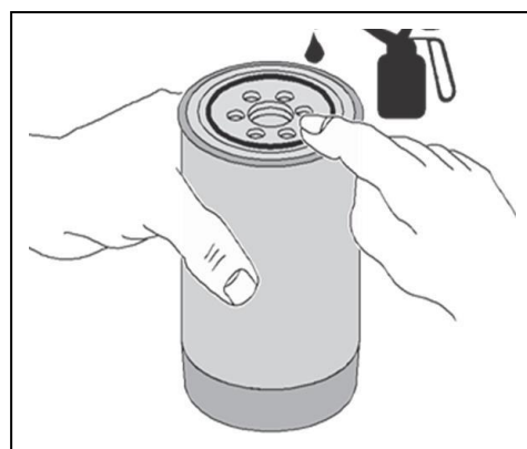
Рисунок 5.3A2 Нанесение масла на прилегающую поверхность
