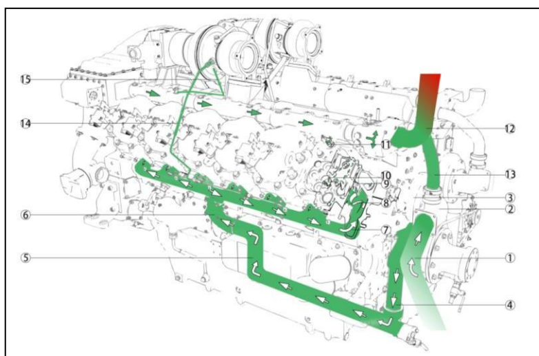
Рис. 2.4А – Схема потоков охлаждающей жидкости (ОЖ), вид справа
