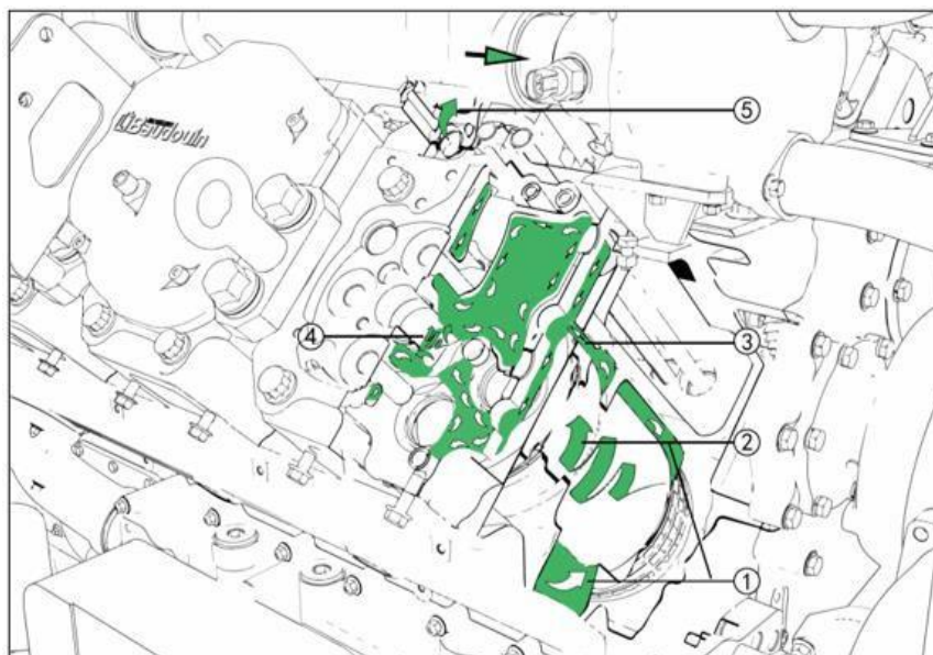
Рисунок 2.4.2В – Схема циркуляции ОЖ вдоль гильзы цилиндра. Двигатель 12М33 1 – Поток ОЖ перед гильзой, 2 – Гильза цилиндра, 3 – Поток ОЖ вдоль стенки цилиндра, 4 – Колодец свечи зажигания, 5 – Выход ОЖ в собирающий коллектор
