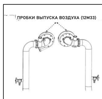
Рисунок 5.3В Спуск воздуха из циркуляционных насосов с шестеренным приводом
