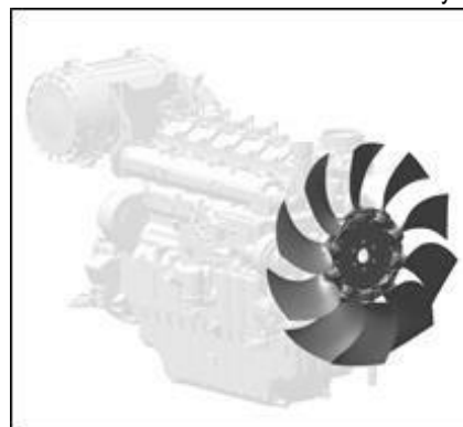
Рисунок 5.3.1Л- Проверка крыльчатки вентилятора
