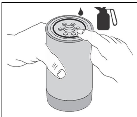
Рисунок 5.3.2.Ж Смазывание контактных поверхностей
