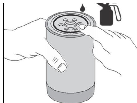
Рисунок 5.3.1Ц- Смазка посадочного места фильтра-элемента
