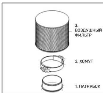
Рисунок 5.3.2.Л Замена отличного по конструкции фильтра
