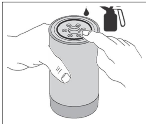
Рисунок 5.3.2.Р Смазка уплотнительного кольца фильтра-элемента
